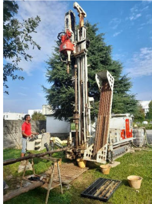
Figura 2 – S1 Prova SPT
